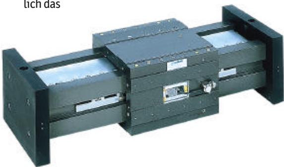
*Bild 1. Luftgelagerte Aluminium-Präzisionsführung mit Linearmotoren und integrierter Messsysteme. Die sehr sprüchlich für die spanende Ultrapräzisionsbearbeitung entwickelten kompakten Führungen werden aufgrund ihrer ausgezeichneten Dynamik zunehmend für die Laserstrukturiertung eingesetzt. Die Laser sind wartungsfrei*
